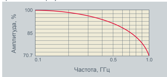
Рис. 1. Типовая амплитудно-частотная характеристика осциллографа общего назначения
